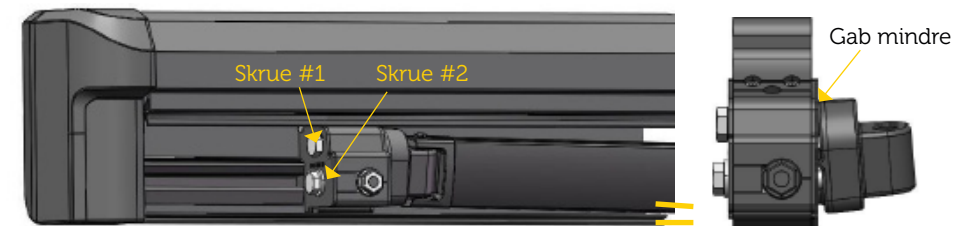
Fig. 2 Højere albueled: løsn skrue #2 og spænd skrue #1
